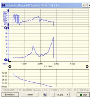
Hochlauf mit InnoAnalyzer Speed: Bei welchen Drehzahlen liegen die Resonanzen meiner Maschine?
